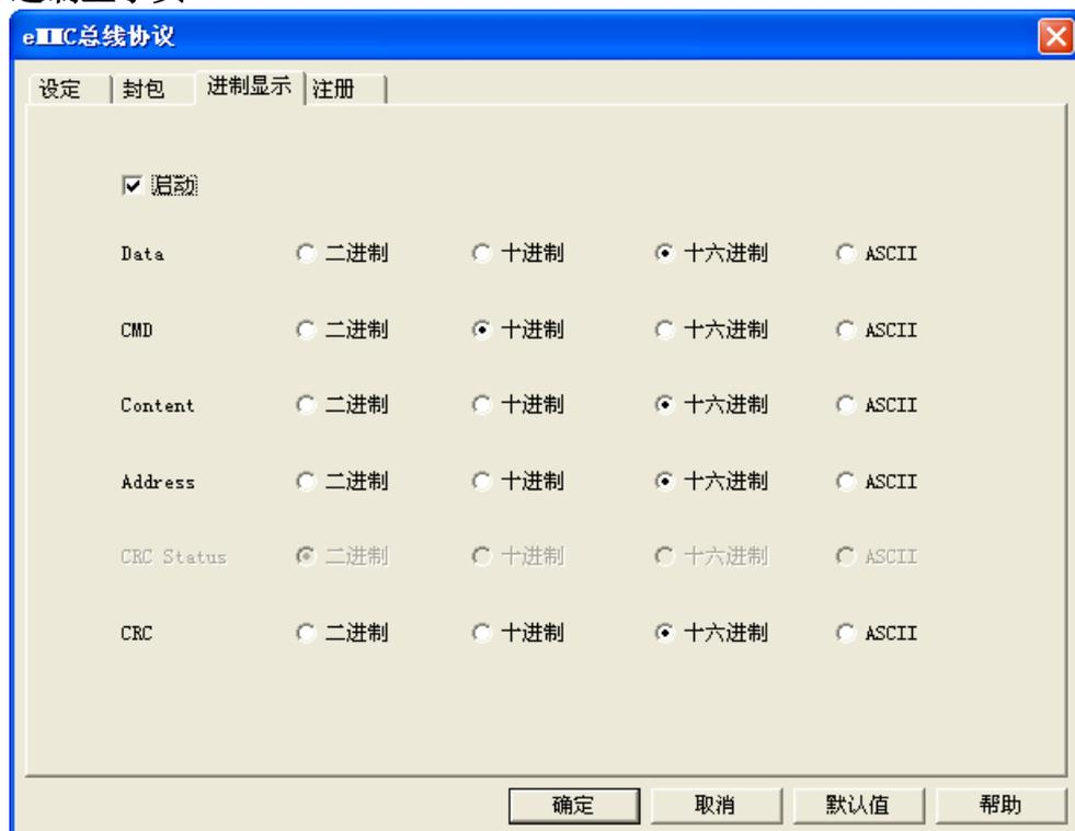
当启用自定义进制显示时，Data、CMD、Content、Address、CRC 用户可自定义其进制；波形区、封包列表 Data、CMD、Content、Address、CRC 数据格式受模组控制。不启用时，为灰色状态，不可点选进制设定。CRC Status 固定为二进制，不可进行设定。
