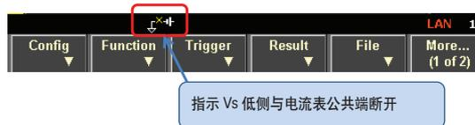
图 10. 将 Vs 低侧设置为浮置状态的步骤
